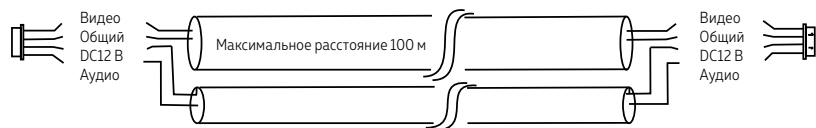
Рис. 8 Комбинированный видеокабель для подключения видеодомофона
