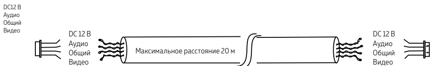
Рис. 9 Витая пара для подключения видеодомофона
