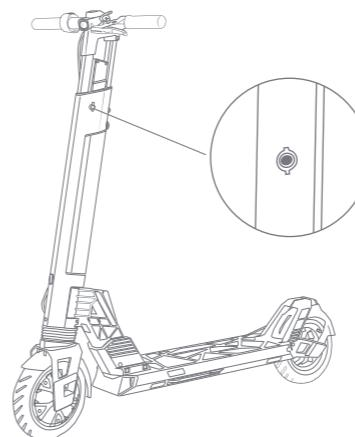
АКБ рулевого вала может быть извлечена и заряжена отдельно, при помощи подставки, входящей в комплектацию самоката.
