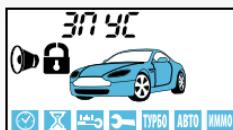
затем - индикация работающего двигателя, режима включенной охраны и оставшегося времени прогрева двигателя (r10, r20, r30, r99):
