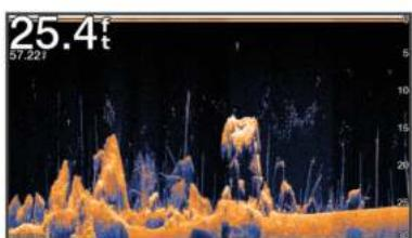
В обычных датчиках используются конусообразные лучи. Для сканирующего сонара Garmin ClearVü предусмотрено использование двух узких лучей, схожих по форме с лучом копировального аппарата. Эти лучи обеспечивают более четкое, напоминающее фотографию изображение пространства под судном.
