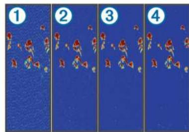
При последовательной установке значения ①, соответствующего выключенному состоянию, минимальной ②, средней ③ и максимальной ④ чувствительности уровень шума постепенно снижается, но это практически не влияет на сильные эхо-сигналы, отраженные от целей. Для удаления помех с экрана следует использовать настройку, максимально снижающую помехи и улучшающую изображение. Чтобы полностью устранить помехи, необходимо исправить проблемы, связанные с установкой устройства.
