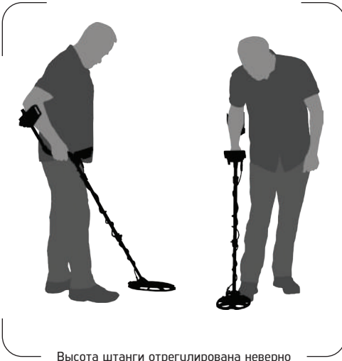
Высота штанги отрегулирована неверно
