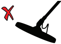
Неверный угол поисковой катушки к земле
