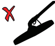
Неверный угол поисковой катушки к земле
