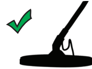
Правильный угол поисковой катушки к земле
