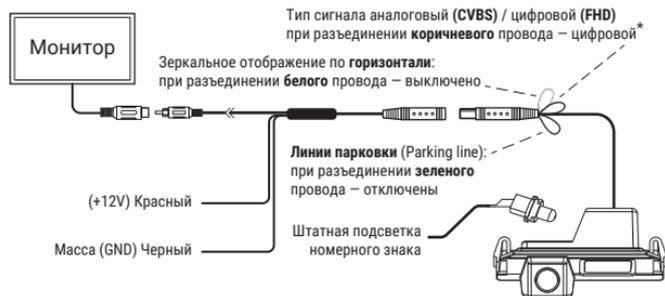
**ВНИМАНИЕ!** Размыкать и замыкать провода линий парковки, зеркального отображения и типа сигнала необходимо только на отключенной от питания камере!
