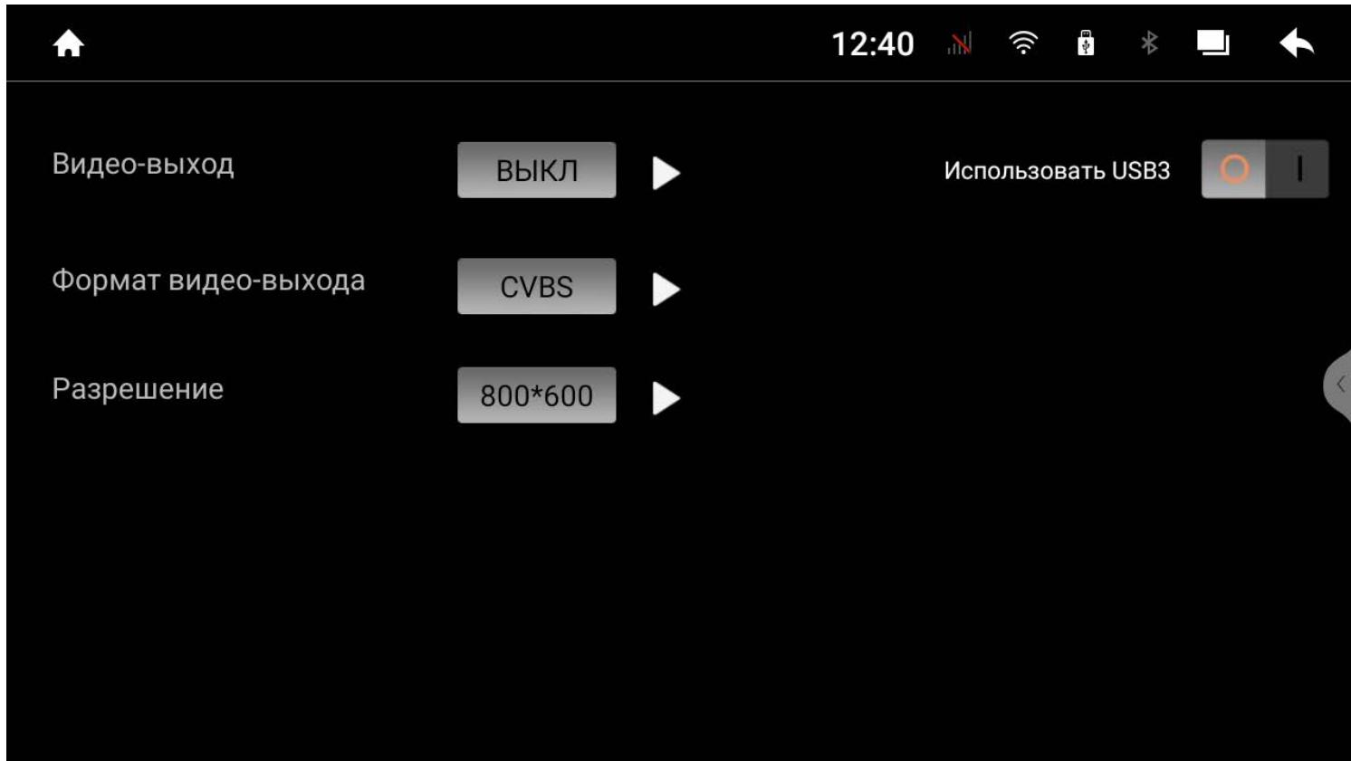
В данном приложении вы можете включить или выключить видеовыход, выбрать тип сигнала: **CVBS** или **HDMI**, выбрать разрешение видео, включить или выключить **USB3**.
