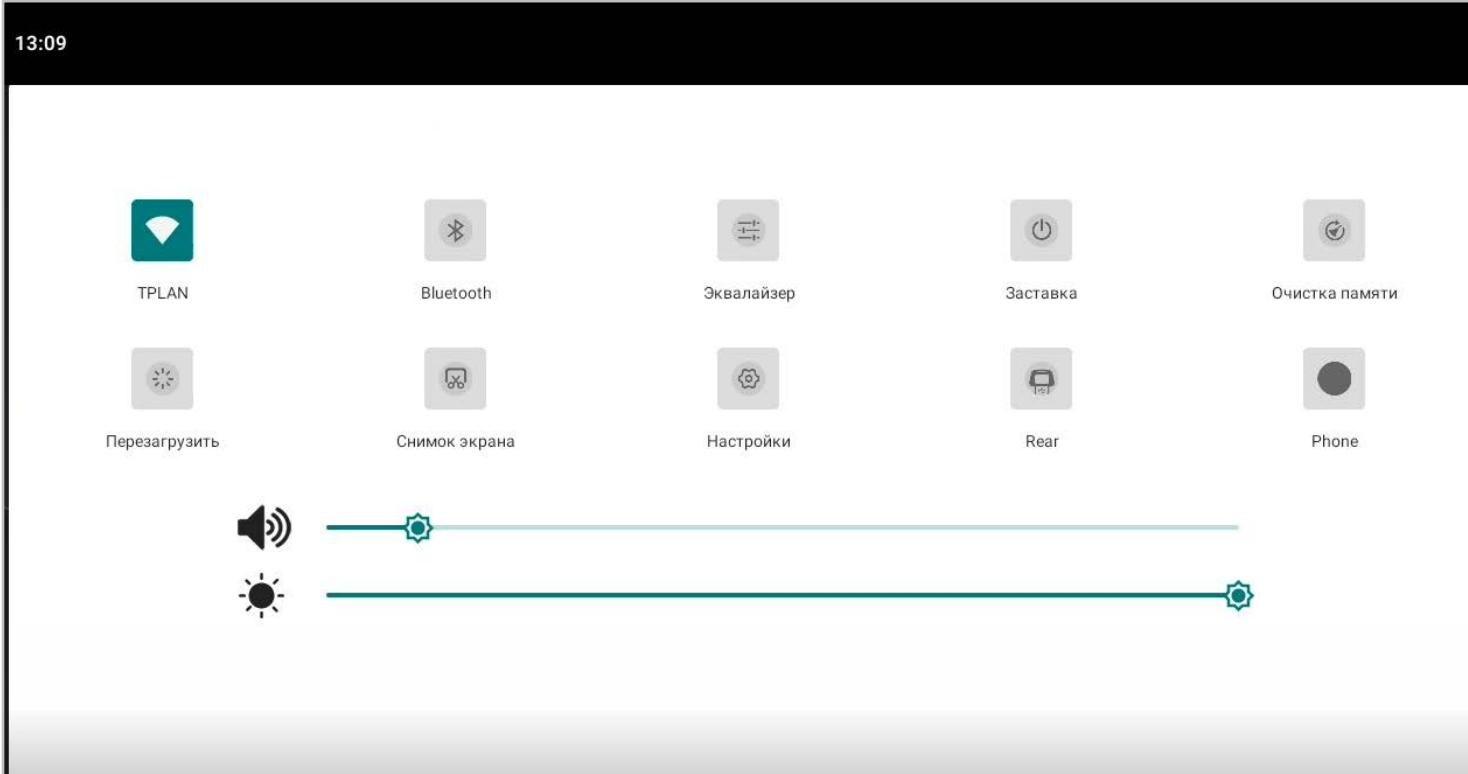
Проведите пальцем от верхней границы экрана вниз, чтобы открыть шторку с быстрыми настройками: *Wi-Fi, Bluetooth, Эквалайзер, Заставка, Очистка памяти, Перезагрузка, Снимок экрана, Настройки, Rear* (внешний дисплей, при наличии внешнего адаптера *USB–HDMI* или *USB–Video*), *Phone*.
