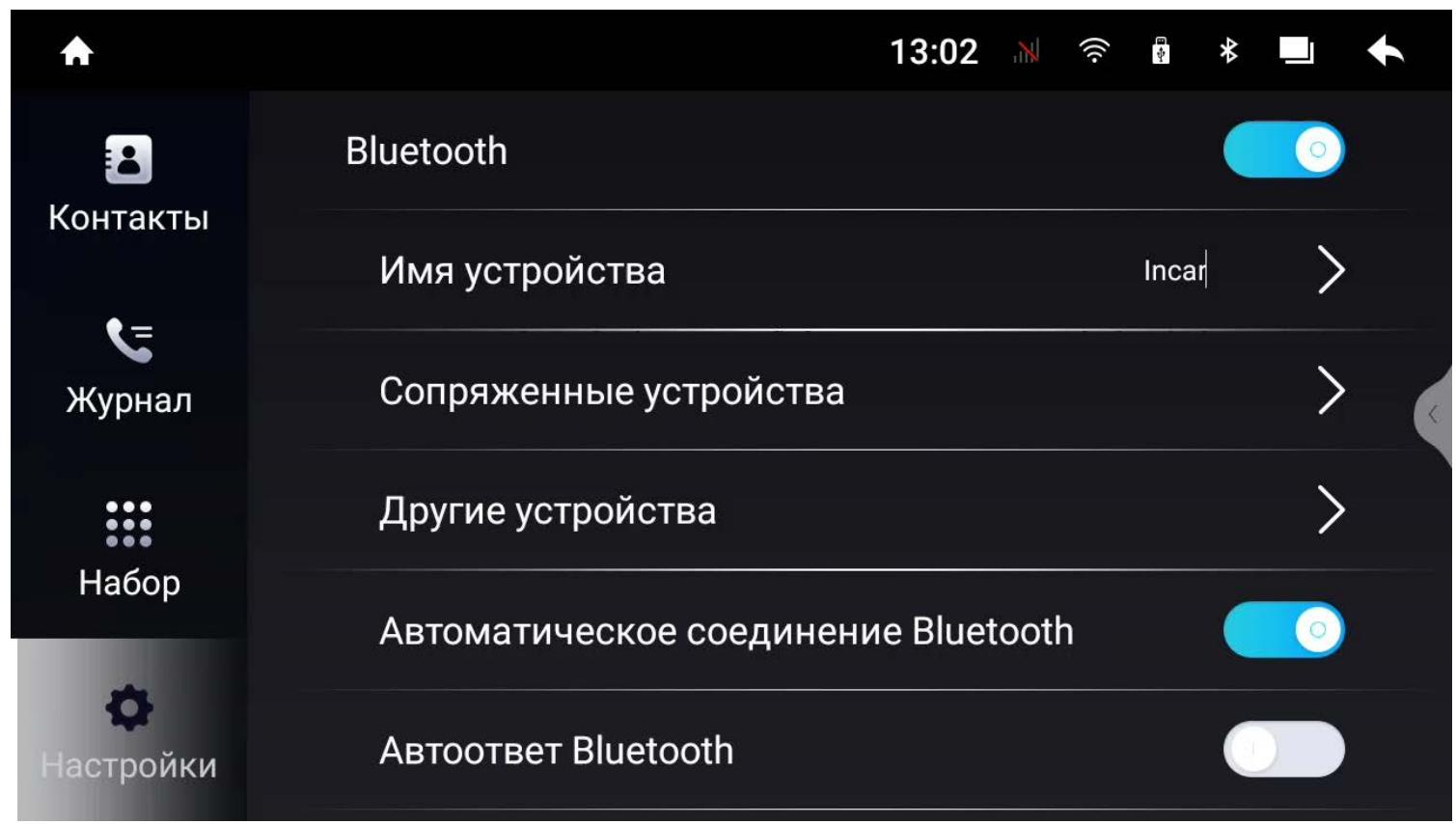
В настройках вы можете включить или выключить Bluetooth, изменить имя устройства, просмотреть или изменить список сопряженных устройств, произвести поиск других устройств, включить или выключить автоматическое подключение при обнаружении устройства из списка сопряженных, включить или выключить автоответ при входящем звонке.
