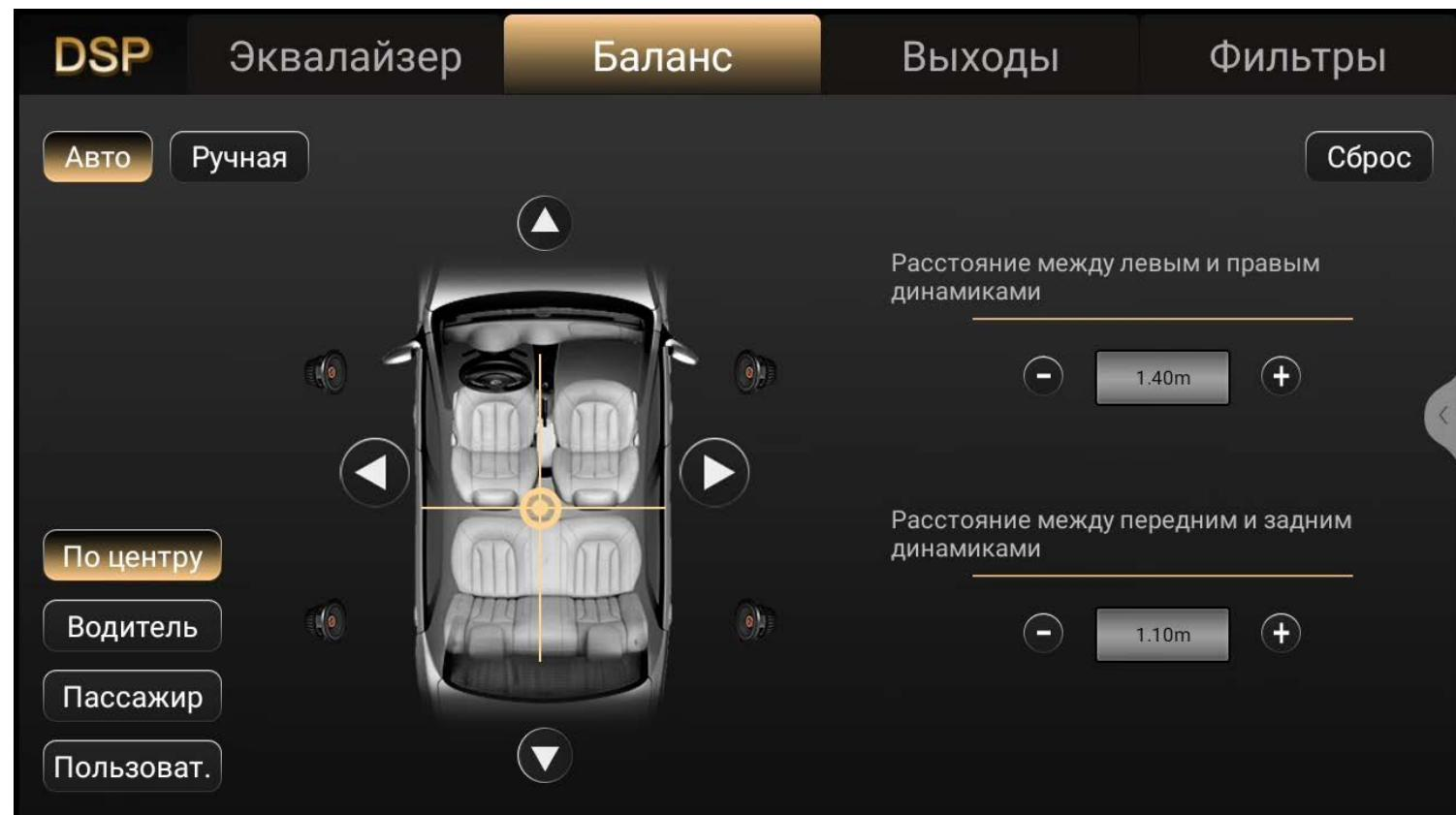
Для точной коррекции автоматической настройки временных задержек внесите в устройство параметры: расстояние между передним левым и передним правым динамиками, а также расстояние между передними и задними динамиками вашего автомобиля.
