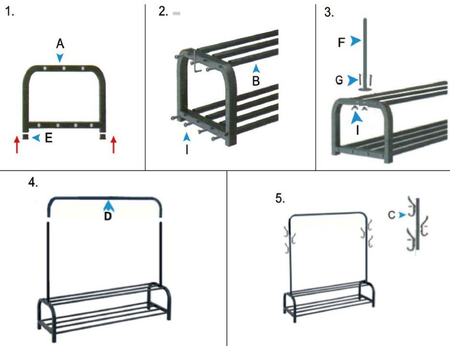
**Примечание.** В процессе сборки винты не должны быть закручены слишком туго, затем после сборки всех деталей винты закручиваются туго. Данный процесс обеспечит лучшую устойчивость вешалки для одежды.
