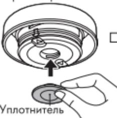
Чтобы снять уплотнитель верхней крышки, отогните его край и потяните, чтобы извлечь из отверстия на нижней части крышки.
