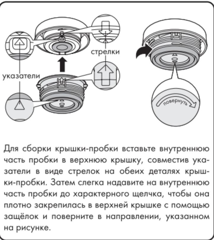
Для сборки крышки-пробки вставьте внутреннюю часть пробки в верхнюю крышку, совместив указатели в виде стрелок на обеих деталях крышки-пробки. Затем слегка надавите на внутреннюю часть пробки до характерного щелчка, чтобы она плотно закрепилась в верхней крышке с помощью защёлок и поверните в направлении, указанном на рисунке.
