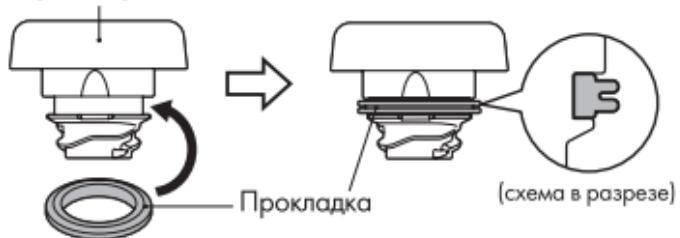
Вымытую и просушенную прокладку установите на основание верхней крышки как показано на рисунке. Для плотного прилегания прокладки равномерно надавите пальцем по всей окружности уплотнителя.
