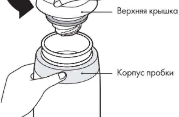
Специальная конструкция крышки-пробки позволяет быстро и легко открывать и закрывать термос, т.к. для этого достаточно повернуть верхнюю крышку на четверть оборота – 90°.
