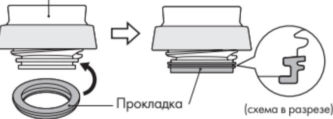
Установите прокладку плоской стороной на нижнюю часть корпуса пробки, немного растянув, чтобы пазы прокладки совпали с выступами на основании корпуса пробки. Равномерно надавите пальцем по всей окружности прокладки для плотного прилегания к основанию корпуса пробки.
