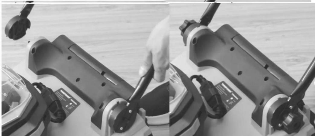
▪ Расположите верхнюю рукоятку поверх нижней ручки и совместите отверстия. Проденьте два крепежных винта. Установите крепежные винты и затяните вручную.
