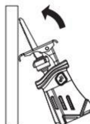
Погружная резка пильным полотном с зубьями на нижней кромке
