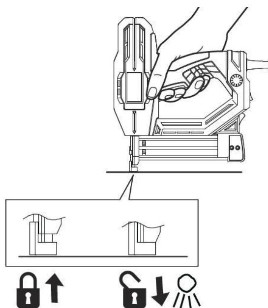
**ПРИМЕЧАНИЕ!** Перед сшиванием держите инструмент и надавливайте на рабочую заготовку, чтобы обеспечить полное проникновение скобы/гвоздя.
